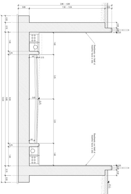
SEZIONE TIPO IN GALLERIA - SCATOLARE A SPINTA - Scala 1:50 -
